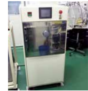
バレルタイプの プラズマ処理 装置
